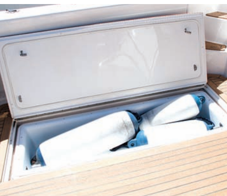
En el suelo los cofres disponen de desagüe y buena capacidad.
